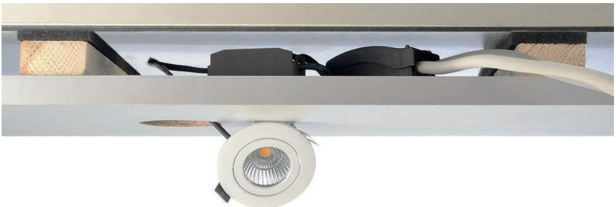
5 - Das Ergebnis: eine kompakte Installation mit einem schwenkbaren Spot, einem dimmbaren Netzgerät sowie der Möglichkeit zur Durchgangsverdrahtung mittels Quick-Anschlussbox bei nur 25 mm Platzbedarf im Deckenhohlraum. Es wird kein zusätzliches Installationsmaterial benötigt – ideal im Sanierungsbereich.
