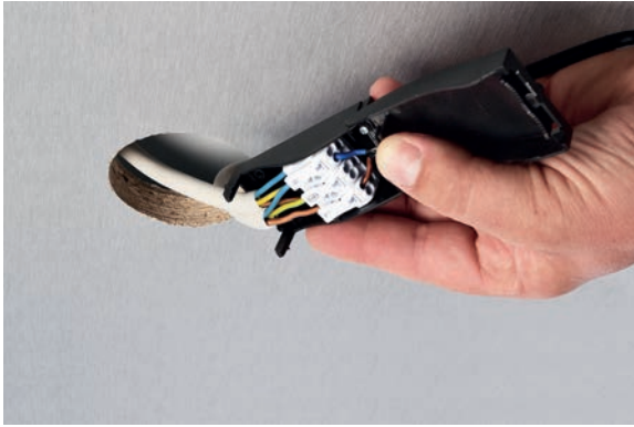
1 - Schnelle Verkabelung / Durchgangsverdrahtung an der Quick-Anschlussbox durch schraublose Steckklemmen auch für 3x 1,5 mm 2 NYM Installationskabel inkl. Zugentlastung
